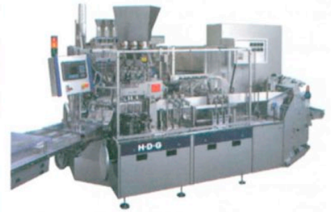
HDG-Beutelmaschinen können optional neben Siegeltemperatur und -zeit auch die Siegelkraft überwachen.
